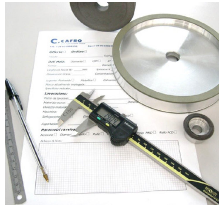
U.13 - U.14: *Taladro Ø50 para máquina de afilado de cuchillas Göckel modificable a Ø75 para máquina Reform y a Ø127 para máquina MVM
